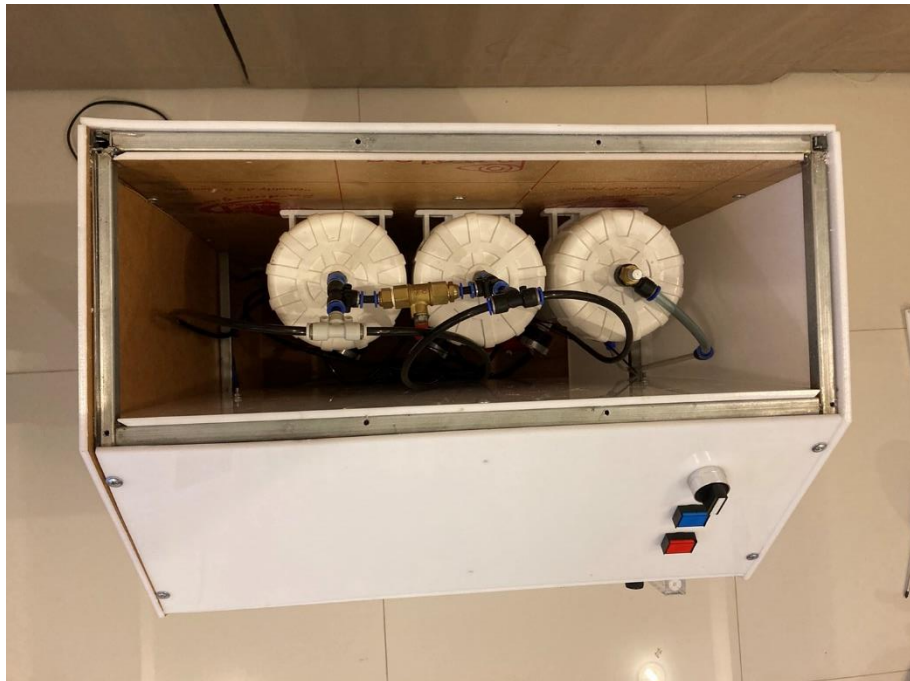
ภาพที่ 4 ชุดกระบอกทำงานประกอบไปด้วยกระบอกแยกออกซิเจนสำหรับเครื่องรอบแรก กระบอกแยกออกซิเจนสำหรับเครื่องรอบหลัง และกระบอกเก็บออกซิเจนบริสุทธิ์
