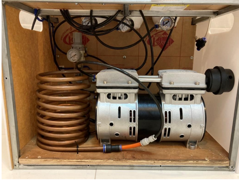
ภาพที่ 3 ภาพแสดงมอเตอร์ปั๊มขนาด 650W ขดลวดสำหรับลดความร้อนของอากาศอัด
