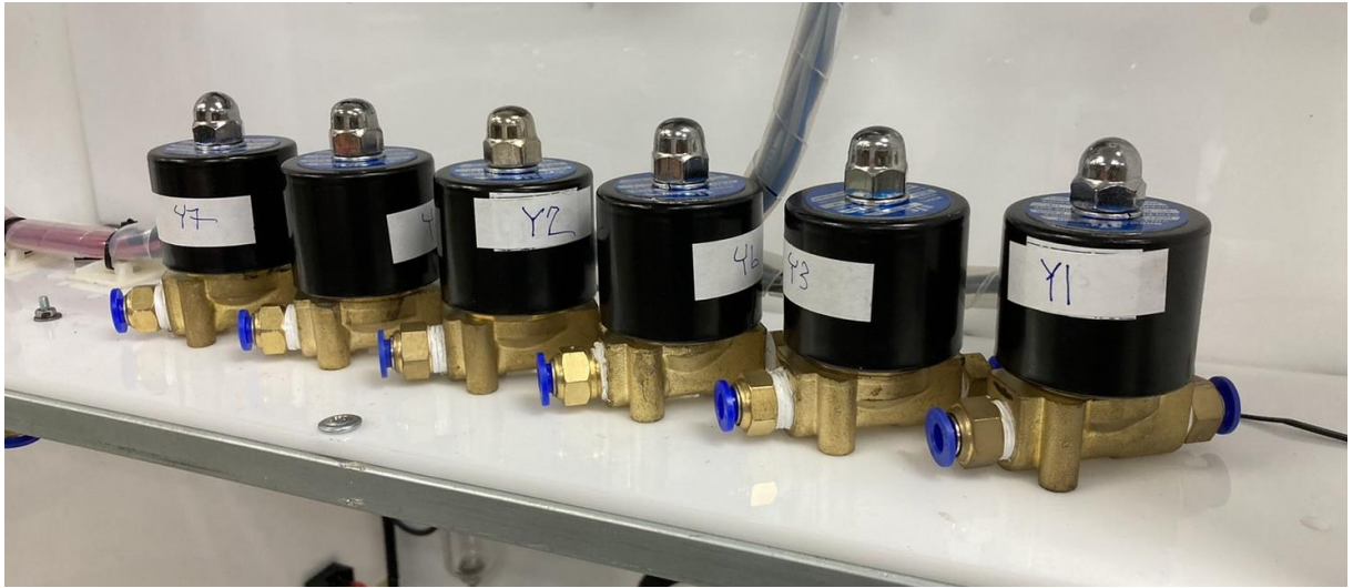
ภาพที่ 5 ภาพวาล์วเปิด-ปิดระบบลม
